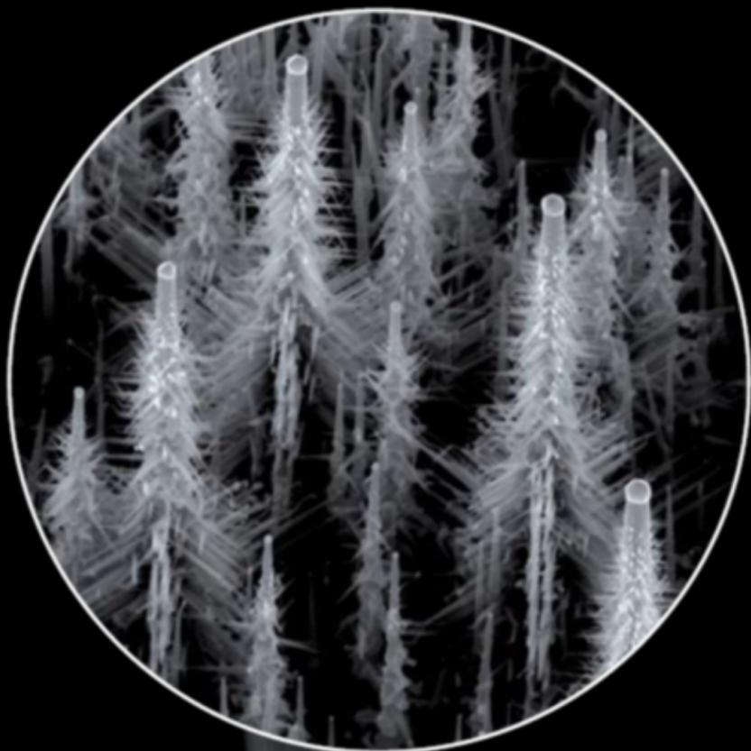
▲ Vues d'ensemble et de dessus de nanostructures de silicium branchées, réalisées en microscopie électronique à balayage. Des nanobilles d'or au sommet des « troncs » et au bout des « branches » catalysent leur croissance.
